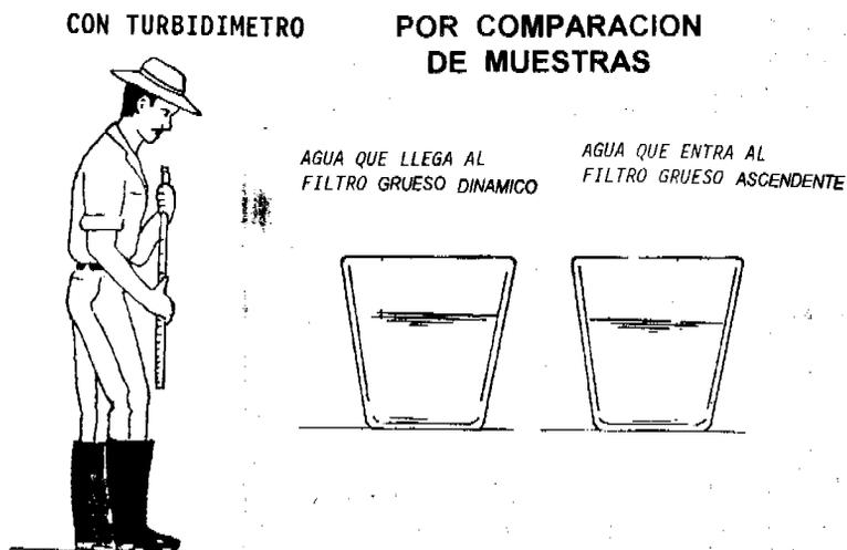
Es importante registrar la turbiedad del agua a la entrada y a la salida (ver Anexo 1), para tener un control sobre el funcionamiento del filtro dinámico y poder tomar decisiones para su operación y mantenimiento.
