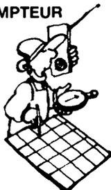
Si l'on ne dispose pas d'appareils enregistreurs, une personne sera chargée d'effectuer les relevés du compteur aux instants préalablement fixés. Elle sera munie d'une fiche de relevés et d'un chronomètre.
