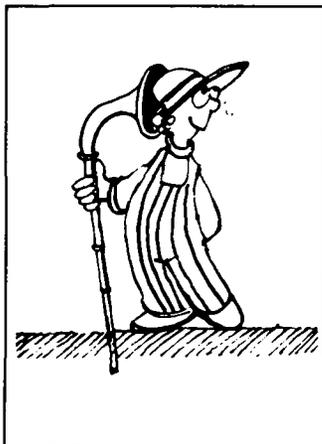
C'est un cornet acoustique renfermant un vibreur amplificateur qui s'adapte sur des allonges métalliques ou des cannes de bambou, le bambou offrant une transmission plus fidèle des bruits. Par contre, il demande un orifice d'accès à la conduite un peu plus important.
