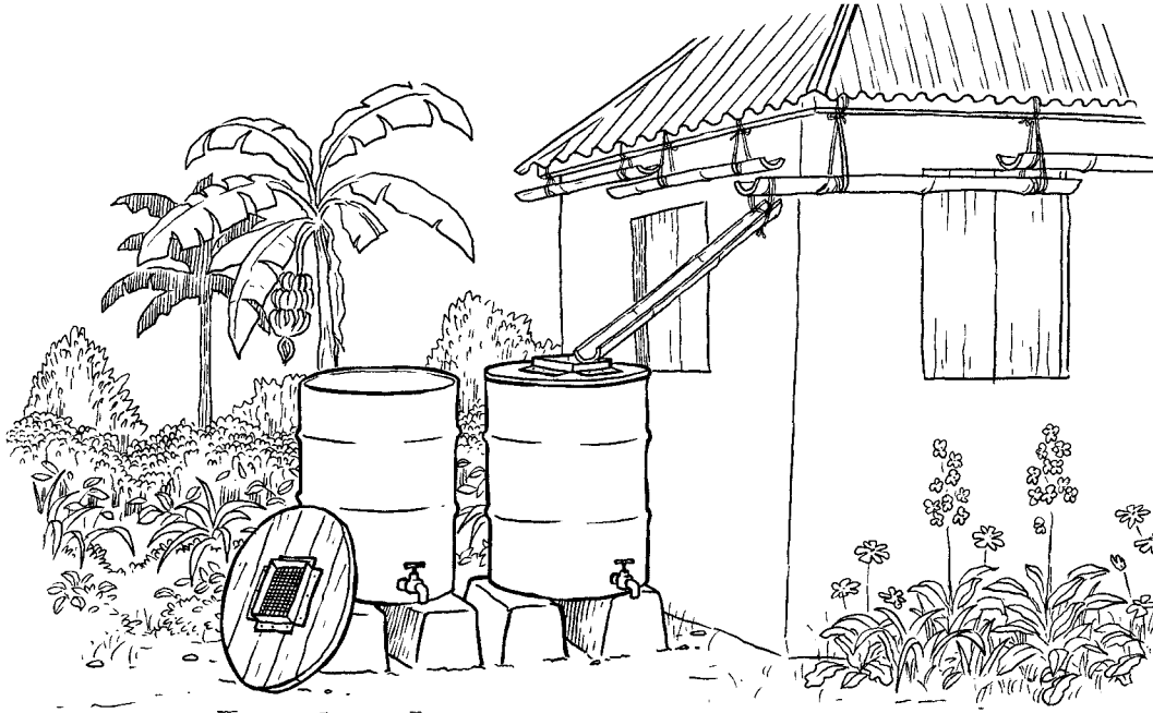
Utilisation d'un toit en fer blanc pour recueillir l'eau de pluie.
